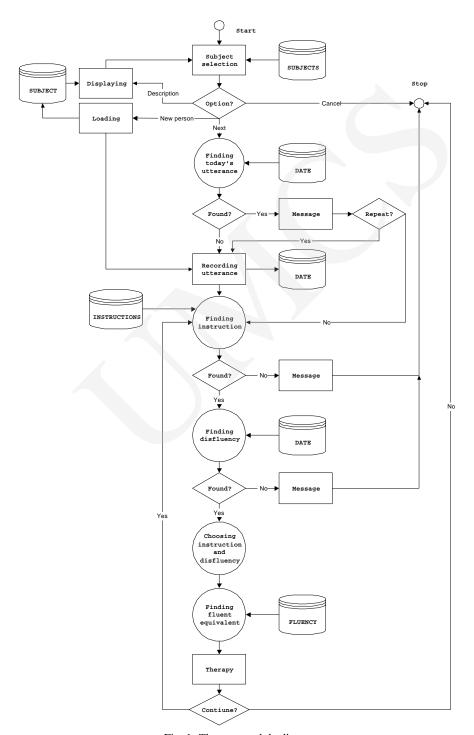
Fig. 1. Therapy module diagram
